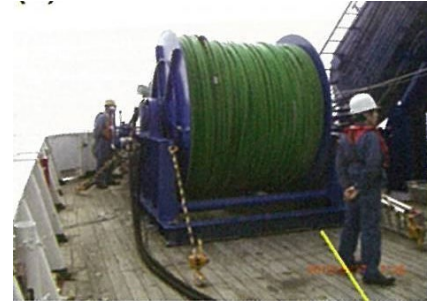
写真-3 ストリーマーケーブル
